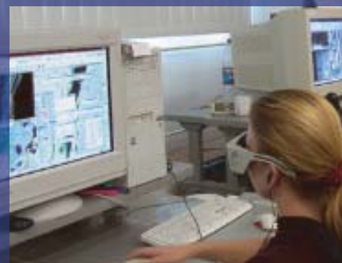
Stereofotogrammetrické mapování na leteckých snímcích; operátorka má na očích 3D brýle
