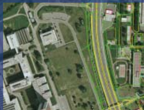
V technické mapě podložené ortofotomapou se uživatel lépe orientuje
