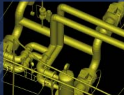
Dokumentace technologických celků pomocí laserového skenování a CAD softwaru
